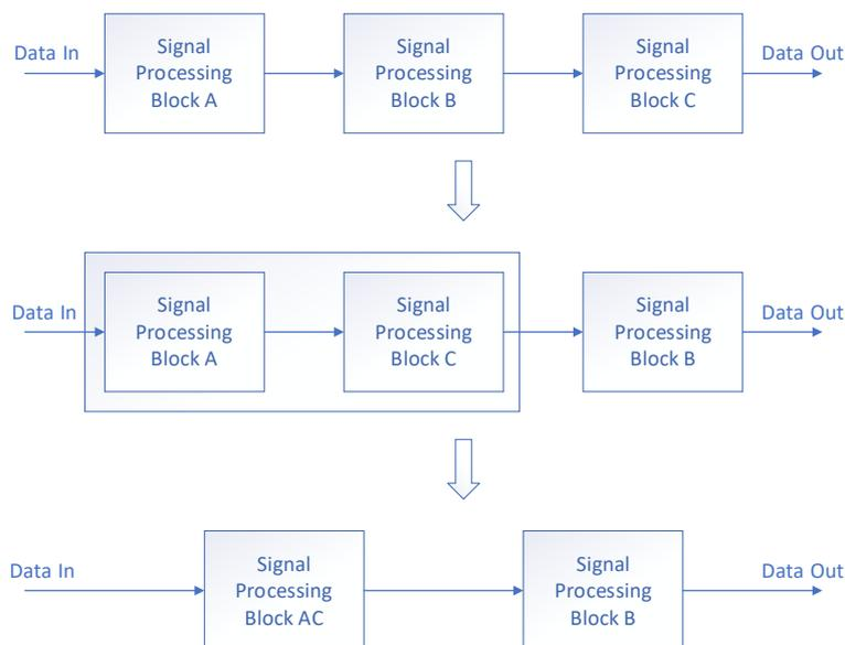
FIGURE 6. REARRANGING FUNCTIONAL BLOCKS TO AVOID REDUNDANCY.
