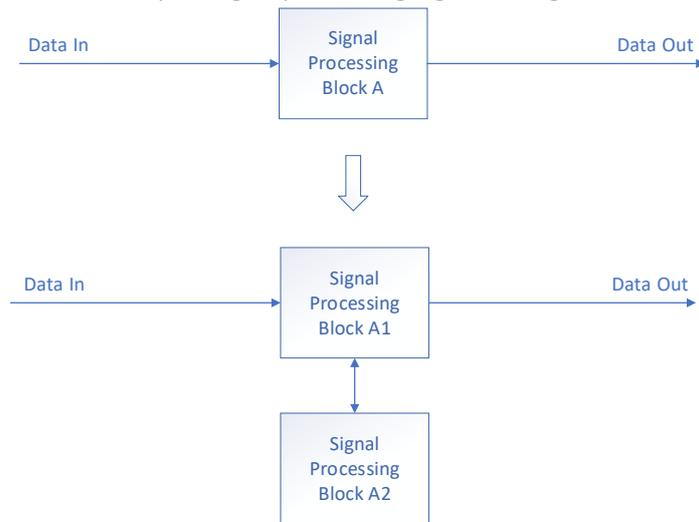
FIGURE 7. REDUCING COMPLEXITY BY SPLITTING SIGNAL PROCESSING BLOCKS.
