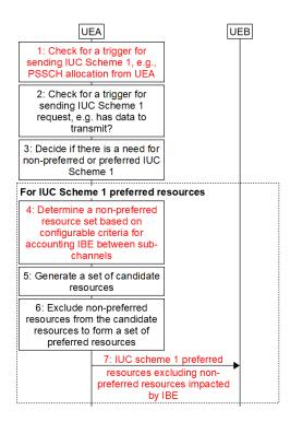
FIGURE 25: IBE-AWARE INTER-UE COORDINATION SCHEME (RED STEPS HIGHLIGHT IMPACT ON EXISTING IUC PROCEDURE).
